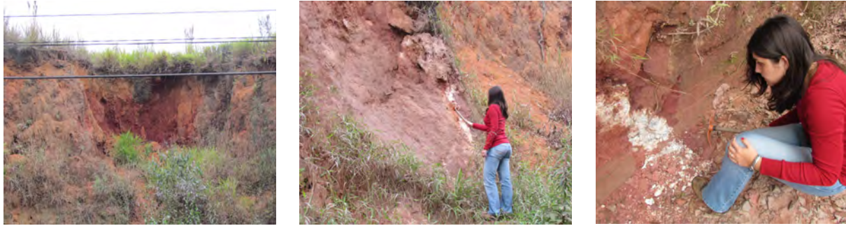
Fotos 6, 7 e 8: Solo exposto à erosão (à direita), com a retirada da vegetação na parte superior. Perfil de solo com horizontes A e B bem espesso (à esquerda). Abaixo, técnica analisando veio de quartzo aparente. Avenida Maria José Ferraz Prado, Itatuba. Crédito: Indaia Emília.
